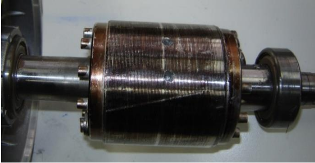
Fig. 6 Défaut deux barres cassées.
